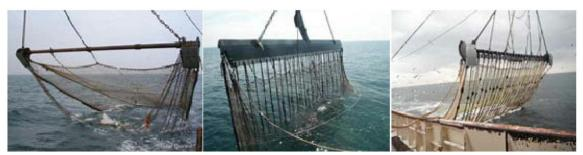
FIGURE 2.1. FROM LEFT TO RIGHT: TRADITIONAL BEAM TRAWL, HFK PULSWING, DELMECO PULSKOR
